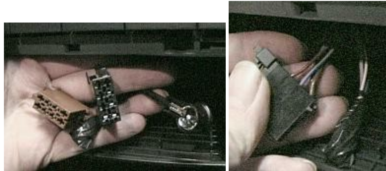
Diese Stecker sind vorhanden. Rechts die isolierten herausgetrennten drei Signalleitungen.
