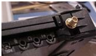
Die ideale Position der RP-SMA-Buchse ist die rechte hintere Ecke des Notebooks, im mittleren der "Lüftungslöcher" -
