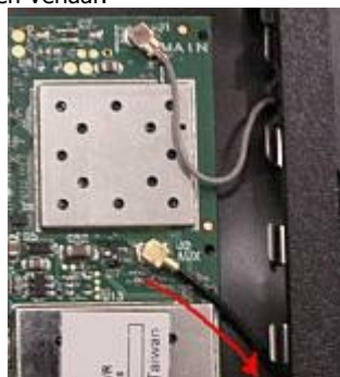
Die ideale Position der RP-SMA-Buchse ist die rechte hintere Ecke des Notebooks, im mittleren der "Lüftungslöcher" -
