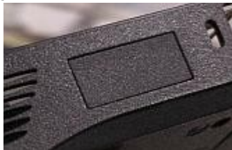
Rechte Seite des Notebooks, zwischen rechtem Lautsprecher und Kensington Lock: Die WLAN-Antenne!
